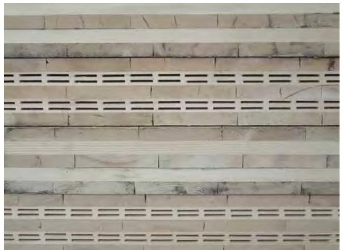
Abb. 117: Brettsperrholz-Probekörper (5-lagig, 90 / 90 / 16 cm) mit und ohne Lufthohlräume.
