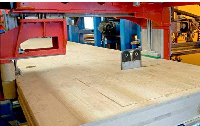
Abb. 89: Kettenschlitzgerät für Abbundanlagen.
