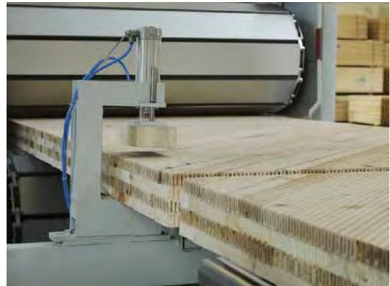
Abb. 34: Geschlitzte Fichten-Seitenbretter. (Dendrolight 2010, <http://www.keplinger.at/dendrolight.html>, Zugriff: 02.02.2010)
