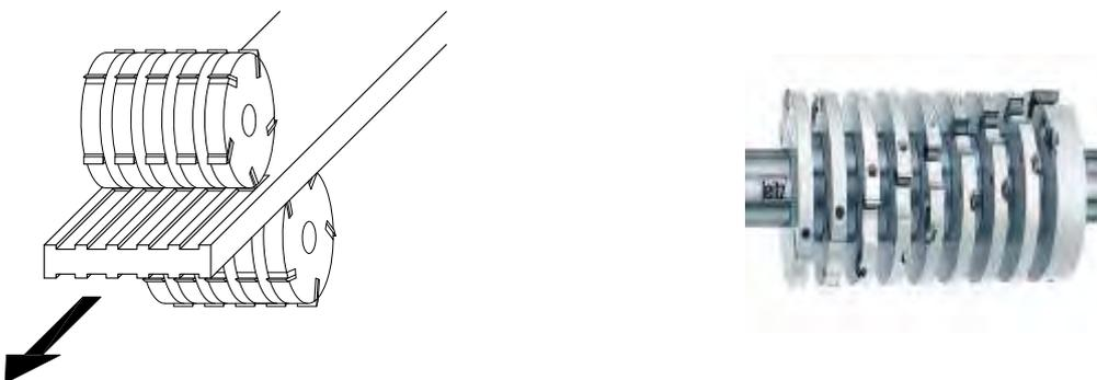
Abb. 84: Skizze: Hobelmesserkopf mit Profileinsatz.
