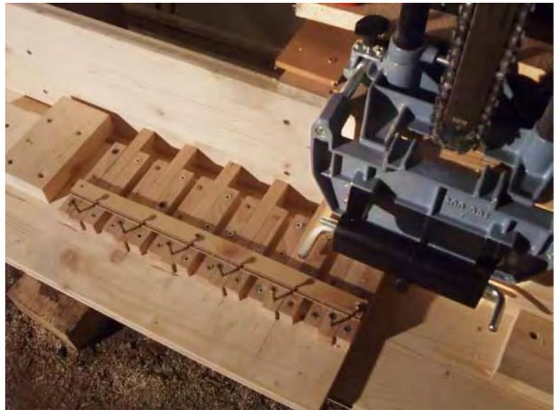
Abb. 116: Fräsen der Lufthohlräume mit dem Schlitzgerät SG 230 bzw. Kettenstemmer LS 103 Ec (Fa. Mafell).
